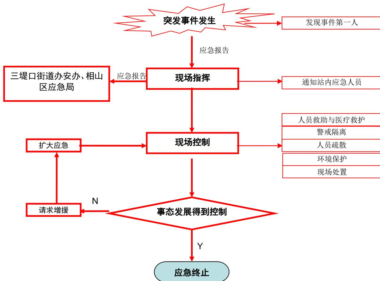
图 7-1 加油站应急响应流程图
