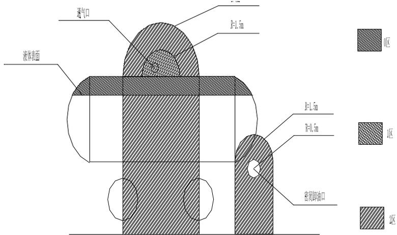
图 3-2 油罐车卸油爆炸危险区域划分
