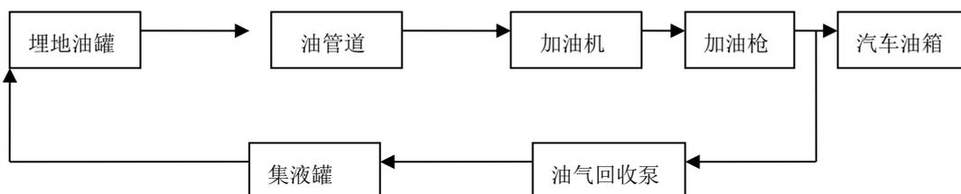
图 2-3 加油工艺流程示意图
