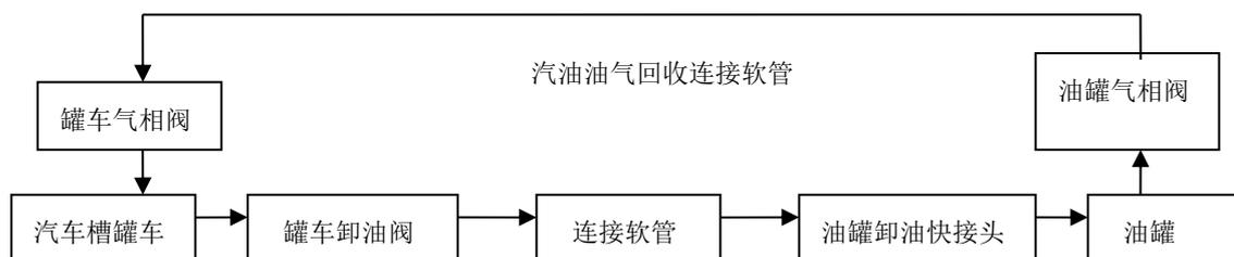
图 2-2 汽油卸油工艺流程示意图
