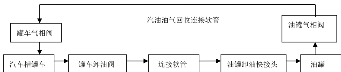
图 2-2 汽油卸油工艺流程示意图
